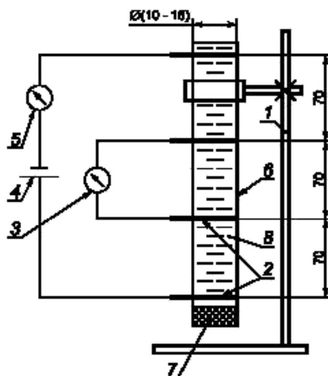
1 — штатив; 2 — электроды; 3 — вольтметр; 4 — источник тока; 5 — микроамперметр;
