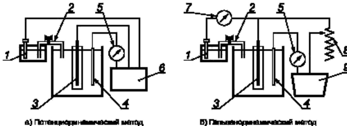
1 — электрод сравнения; 2 — электролитический ключ; 3 — образец; 4 — вспомогательный электрод; 5 — микроамперметр;
