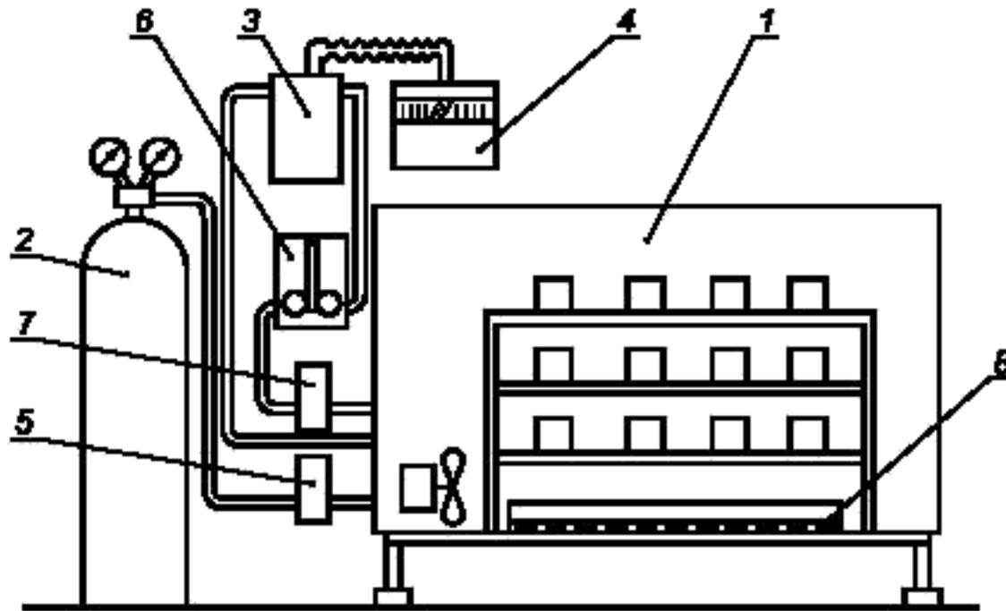
1 — камера; 2 — баллон с  $\text{CO}_2$ ; 3 — автоматический газоанализатор; 4 — показывающий командный прибор; 5 — электромагнитный клапан; 6 — блок регулирования; 7 — побудитель расхода газа; 8 — ванна с раствором хлорида натрия
