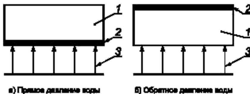
1 — испытуемый образец; 2 — защитное покрытие; 3 — направление подачи воды
