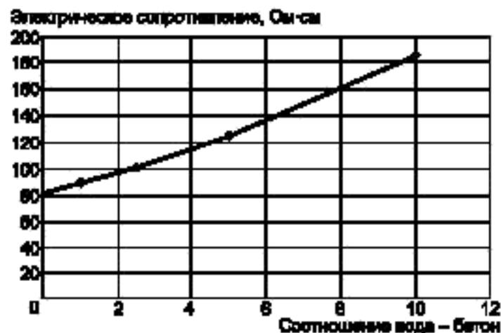
Рисунок 4 — Оценка электрического сопротивления водной вытяжки из бетона
