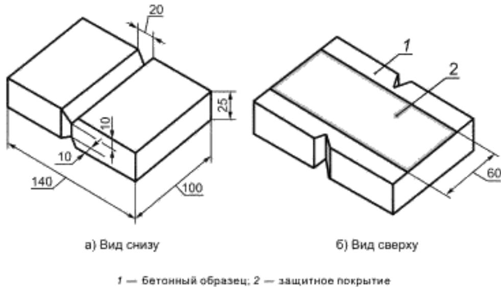
Рисунок 7 — Общий вид образца для определения трещиностойкости
