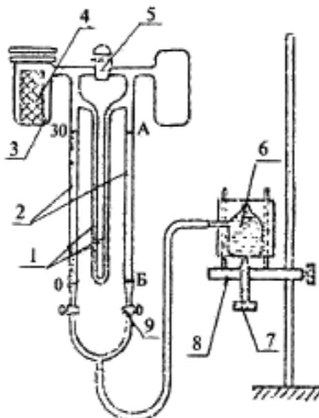
1 — манометр с дибутилфталатом; 2 — ртутный манометр; 3 — камера; 4 — образец;
