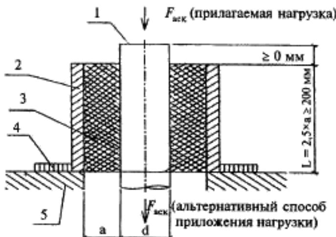
1 — стальная труба; 2 — труба-оболочка из полиэтилена; 3 — изоляция из пенополиуретана; 4 — направляющее кольцо; 5 — плита основания машины для испытания
