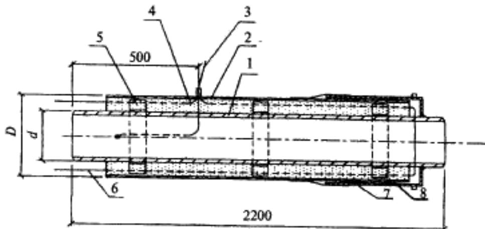
1 — стальная труба; 2 — оболочка из полизтилена; 3 — кабельный вывод; 4 — изоляция из пенополиуретана; 5 — центрирующая опора; 6 — проводник-индикатор системы ОДК; 7 — металлическая заглушка изоляции; 8 — герметик (термоусадоччное полотно)
