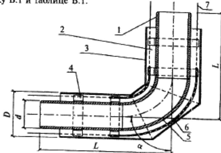
1 — стальная труба; 2 — изоляция из пенополиуретана; 3 — оболочка из полистилен-леновой оболочки; 4 — центрирующая опора; 5 — стальной отвод; 6 — электроизоляционная трубка по ГОСТ 22056; 7 — проводник-индикатор системы ОДК.
