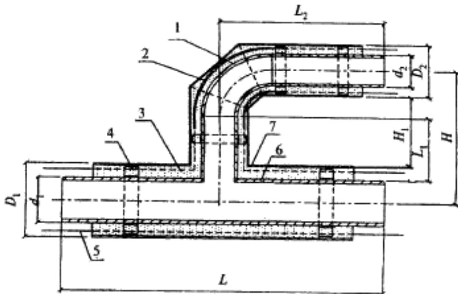
1 — стальной отвод; 2 — электроизоляционная трубка по ГОСТ 22056; 3 — изоляция из пенополиуретана; 4 — центрирующая опора; 5 — проводник-индикатор системы ОДК; 6 — стальная труба; 7 — оболочка из полизтилена
