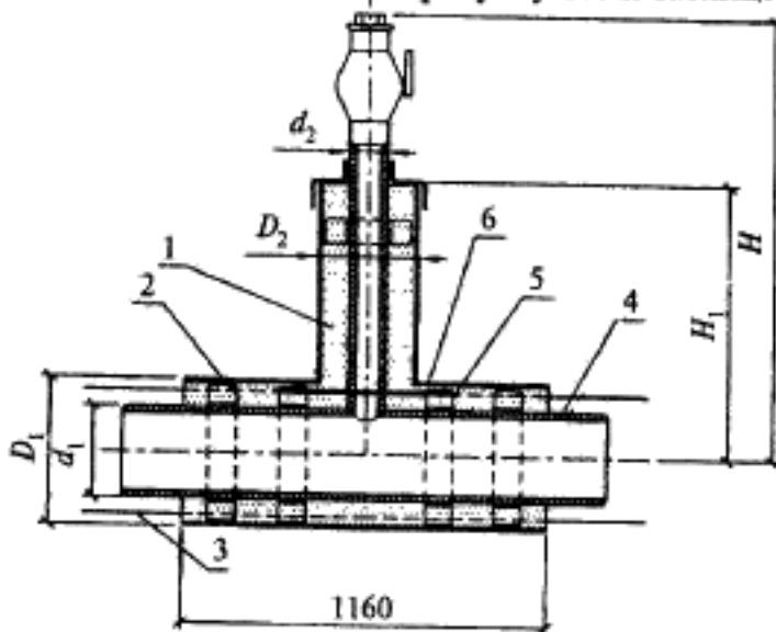
1 — изоляция из пенополиуретана; 2 — центрирующая опора; 3 — проводник-индикатор системы ОДК; 4 — стальная труба; 5 — электроизоляционная трубка по ГОСТ 22056;
