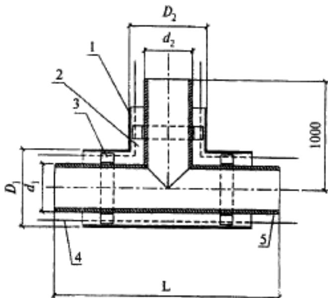
1 — оболочка из полиэтилена; 2 — изоляция из пенополиуретана; 3 — центрирующая опора; 4 — пронодник-индикатор системы ОДК; 5 — стальная труба
