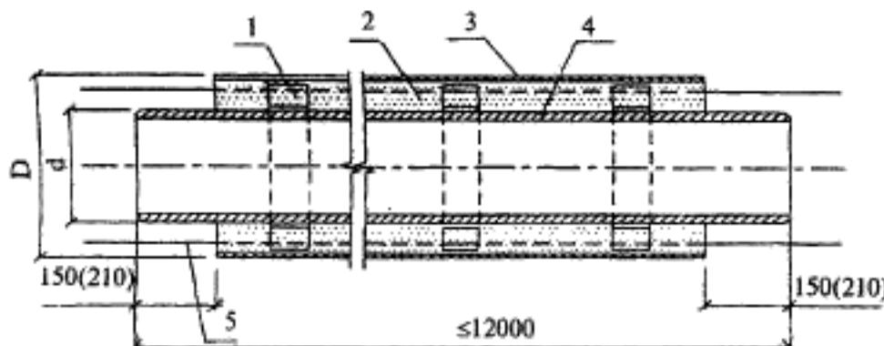
1 — центрирующая опора; 2 — изоляция из пенополиуретана; 3 — труба-оболочка из полизтилена; 4 — стальная труба; 5 — проводники-индикаторы системы ОДК (показаны условно)
