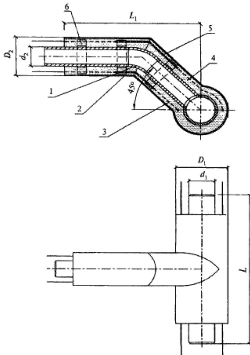
1 — стальной отвод; 2 — оболочка из полизтилена; 3 — проводник-индикатор системы ОДК; 4 — изоляция из пенополиуретана; 5 — электронизоляционная трубка по ГОСТ 22056; 6 — центрирующая опора
