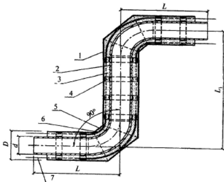
1 — оболочка из полизтилена; 2 — стальная труба; 3 — изоляция из пенополиуретана;
