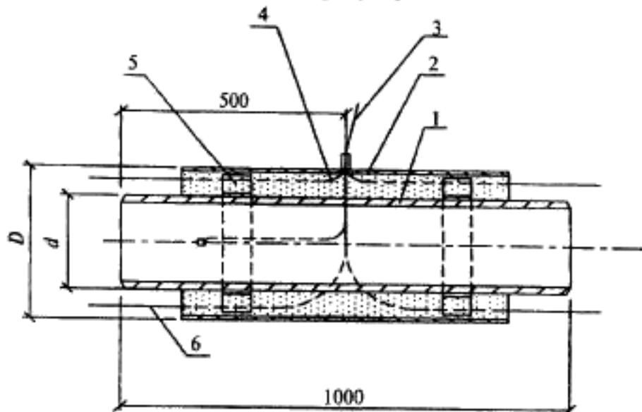
1 — стальная труба; 2 — оболочка из полистиленса; 3 — кабельный вывод; 4 — изоляция из пенополиуретана; 5 — центрирующая опора; 6 — проводник-индикатор системы ОДК
