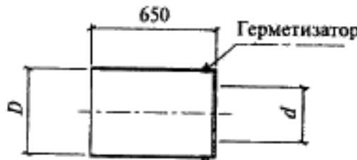
Рисунок В.9 — Металлическая заглушка изоляции
