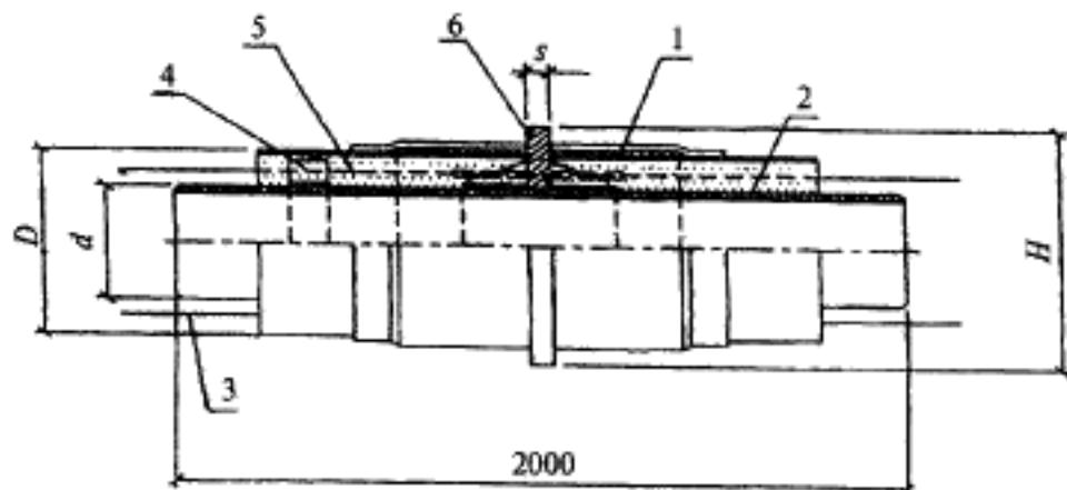
1 — оболочка из полистилена; 2 — стальная труба; 3 — проводник-индикатор системы ОДК; 4 — центрирующая опора; 5 — изоляция из пенополиуретана; 6 — неподвижная опора
