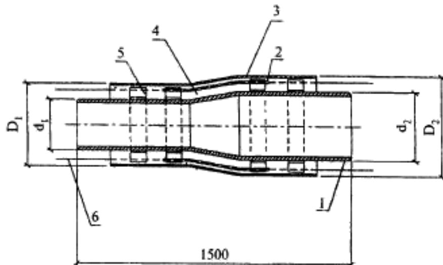
1 — стальная труба; 2 — электроизоляционная трубка по ГОСТ 22056; 3 — оболочка из полиэтилена; 4 — изоляция из пенополиуретана, 5 — центрирующая опора; 6 — проводник-индикатор системы ОДК
