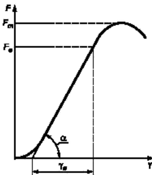
Рисунок 3 — Кривая зависимости сдвига от силы
