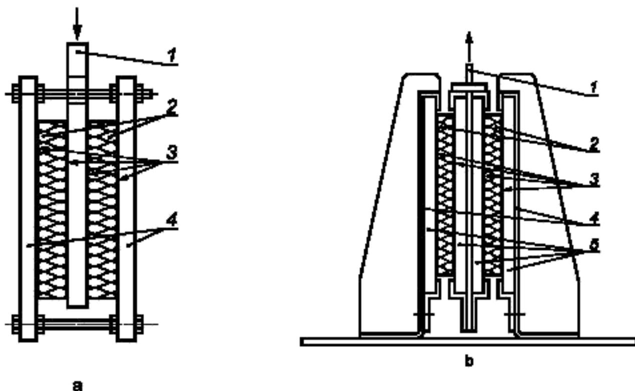
1 — нагружающая пластина (длина 300, ширина 100, толщина 16 мм); 2 — образцы (длина 200, ширина 100 мм); 3 — kleящее вещество; 4 — металлические держатели для образцов (длина 300, ширина 100, толщина 16 мм)
