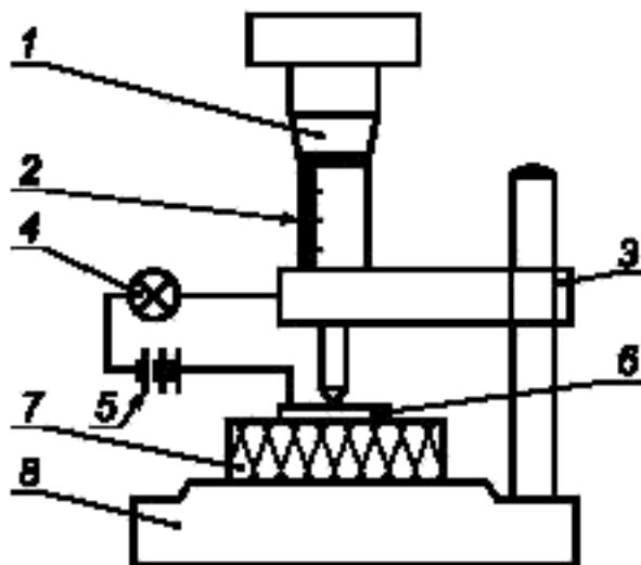
1 — винтовой микрометр; 2 — шкала с делениями в миллиметрах; 3 — регулируемая опора; 4 — лампа; 5 — батарея; 6 — алюминиевая пластина площадью 10 см<sup>2</sup>; 7 — образец для измерения; 8 — основание
