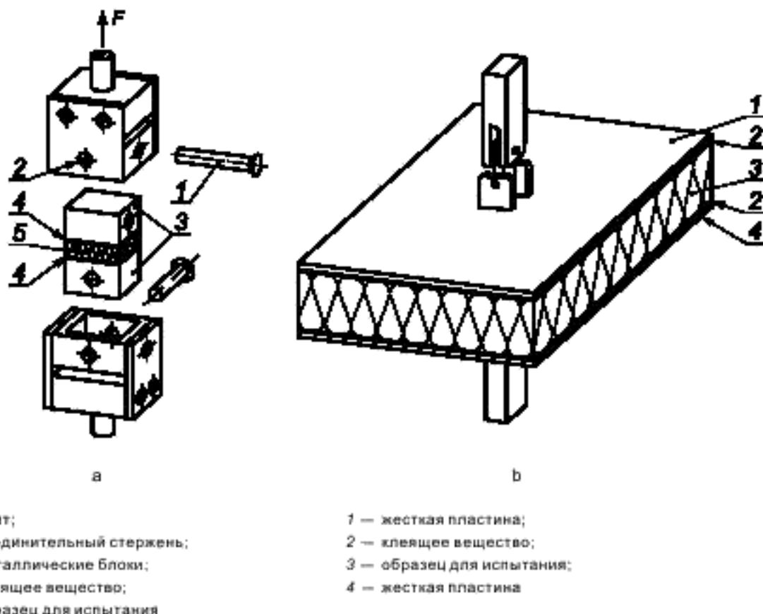
Рисунок 1 — Примеры приспособлений для крепления образца
