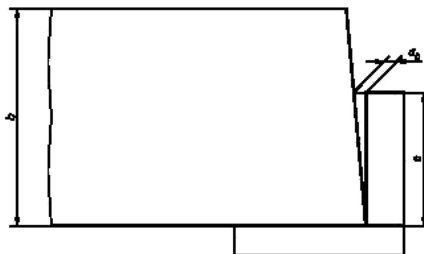
$b$  — длина или ширина изделия в зависимости от угла, по которому проводят измерение;  $a_d$  — отклонение от прямоугольности по длине или ширине;  $c$  — длина внутренней измерительной грани угольника
