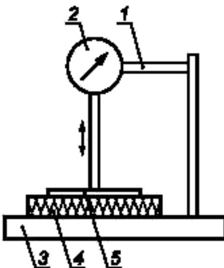
1 — жесткая рама; 2 — прибор с круговой шкалой; 3 — плоское жесткое основание; 4 — образец для измерений;
