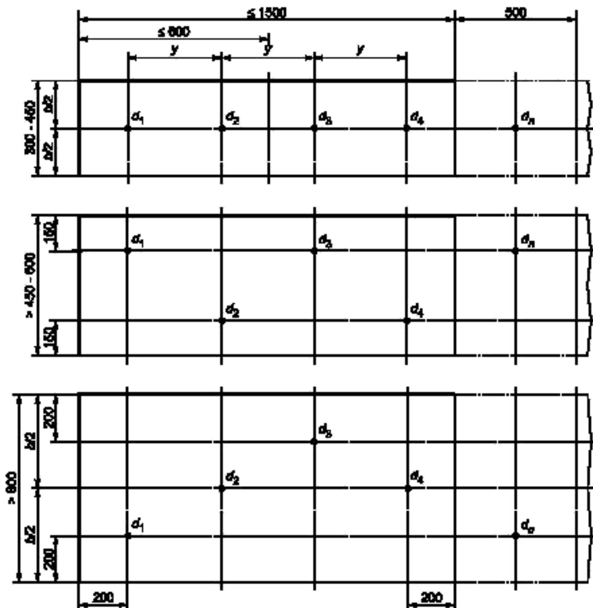
Рисунок 2 — Расположение точек, в которых проводят измерения
