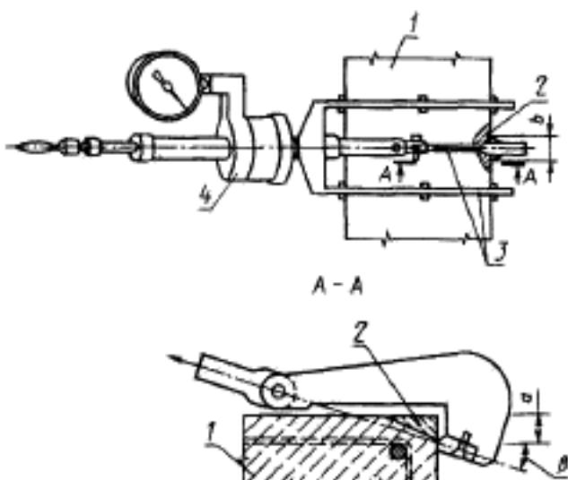
1 — испытуемая конструкция; 2 — скользящий бетон;
