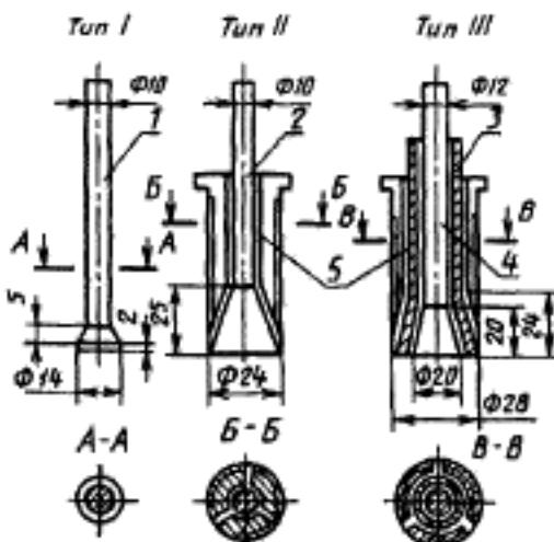
1 — рабочий стержень; 2 — рабочий стержень с разжимным конусом; 3 — рабочий стержень с полным разжимным конусом; 4 — опорный стержень; 5 — сегментные рифленые щеки
