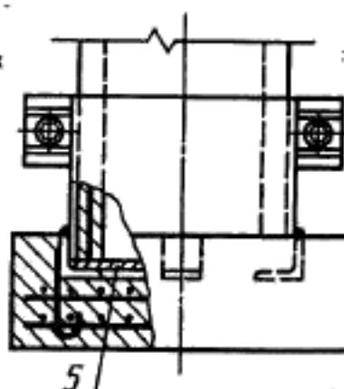
1—опорные диафрагмы; 2—подпятник; 3—коротыши; 4—цементный раствор; ц. т.—центр тяжести стойки;  $l_1$ ,  $l_2$ —расстояния до мест установки опорных диафрагм;  $D_1$ ,  $d_1$ —наружные диаметры стойки;  $D_2$ ,  $d_2$ —внутренние диаметры стойки; 5—асбестовый лист  $D=410$  мм,  $\delta=10$  мм.
