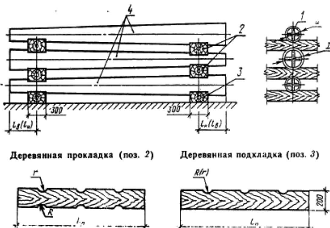
1—опорные диафрагмы; 2, 3—деревянные прокладки и подкладки; 4—стойки;  $L_d$ —длина прокладок (подкладок);  $l_a$ ,  $l_b$ —расстояния от нижнего и верхнего концов стоек до мест установки диафрагмы;  $R(r)$ —радиус выреза.
