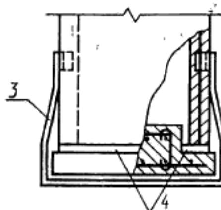
1—опорные диафрагмы; 2—подпятник; 3—коротышки; 4—цементный раствор; ц. т.—центр тяжести стойки; L—длина стойки;  $l_u$ ,  $l_d$ —расстояния до центра тяжести стойки;  $D_1$ ,  $D_2$ —расстояния до мест установки опорных диафрагм;  $D_1$ —внутренний диаметр стойки;  $D_2$ —наружный диаметр стойки
