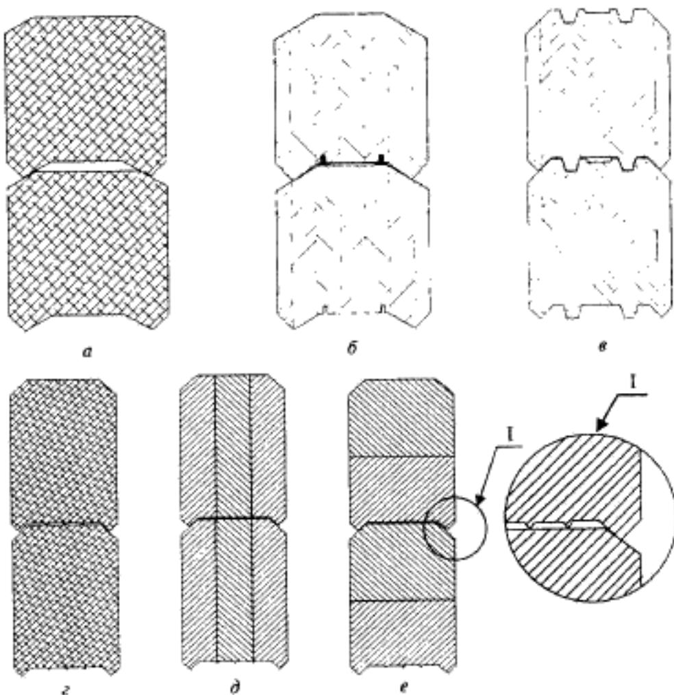
а — трапецидальный венцовый паз; б — трапецидальный венцовый паз с канавками для уплотнителя; в — соединение «шпунт-гребень» с пазом для плоского уплотнителя; г — трапецидальный венцовый паз с уплотнителем в виде сминаемых треугольных гребней древесины; д, е — то же, для клянчатых брусьев
