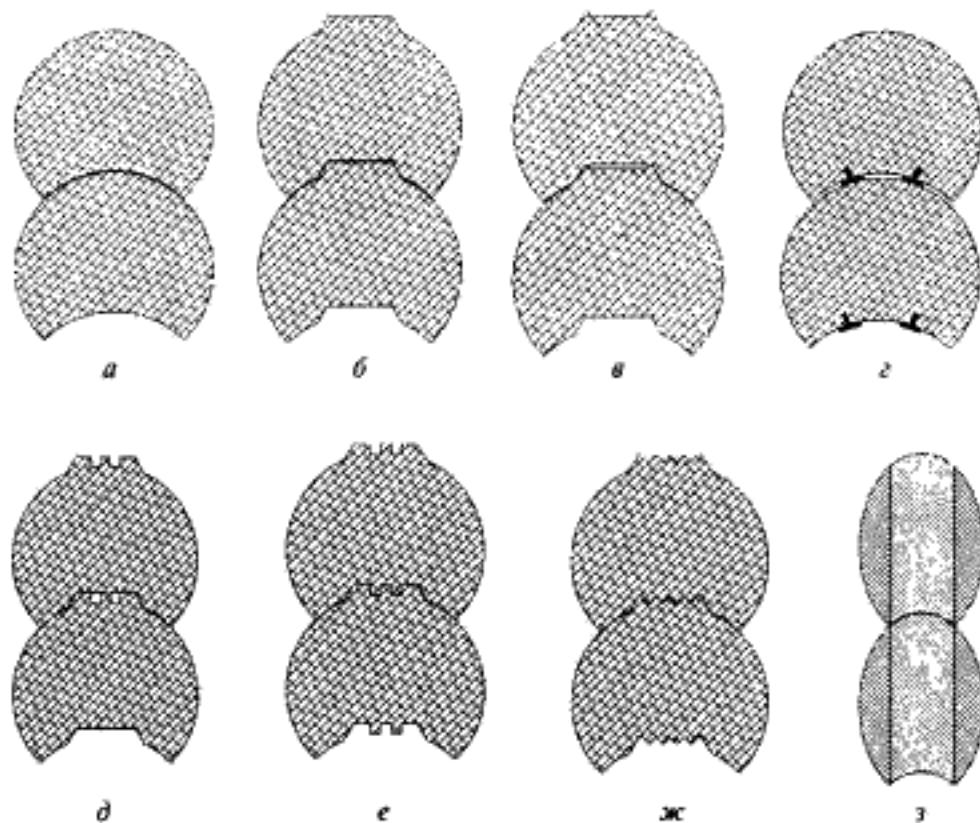
*а* — простой цилиндрический венцовый паз; *б* — трапецидальный венцовый паз; *в* — трапецидальный венцовый паз с канавкой для плоского уплотнителя; *г* — простой цилиндрический венцовый паз с канавками для уплотнителя; *д* — трапецидальный венцовый паз с канавками для уплотнителя; *е*, *ж* — трапецидальный венцовый паз с соединением «шпунт-гребень»; *з* — простой цилиндрический венцовый паз для эллиптического бревна из клееной древесины
