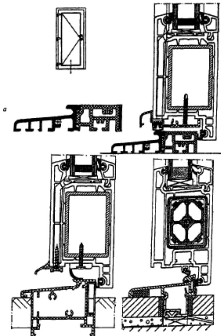
*a* — пример конструкции порога из алюминиевого сплава и конструкционного полипамида для наружных дверных блоков
