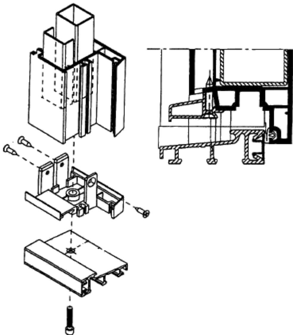
*Рисунок 10 — Пример крепления порога (механическое соединение)*
