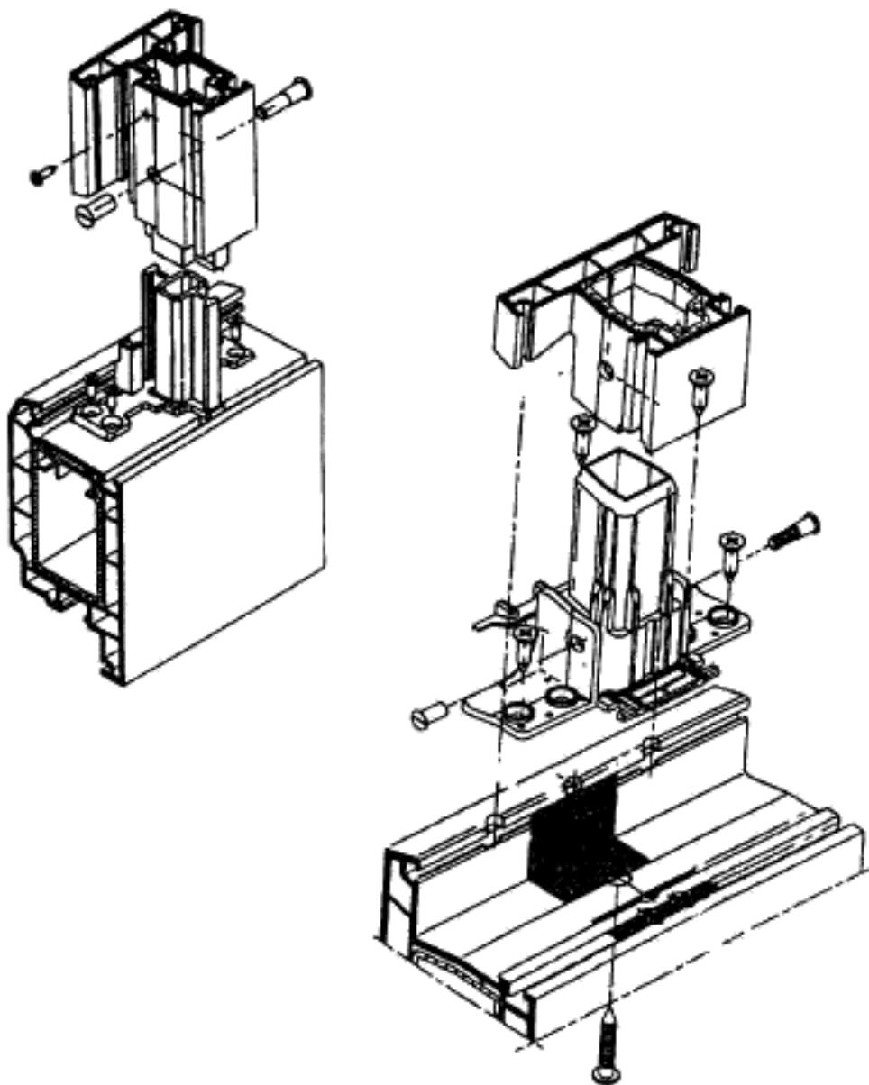
Рисунок 9 — Примеры крепления импостов (механическое соединение)
