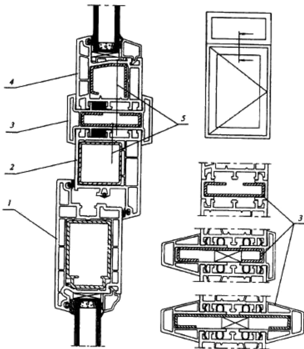
1, 2 — полотно и коробка дверного блока; 3 — соединители; 4 — коробка неоткрывающейся фрамуги; 5 — крепежный элемент
