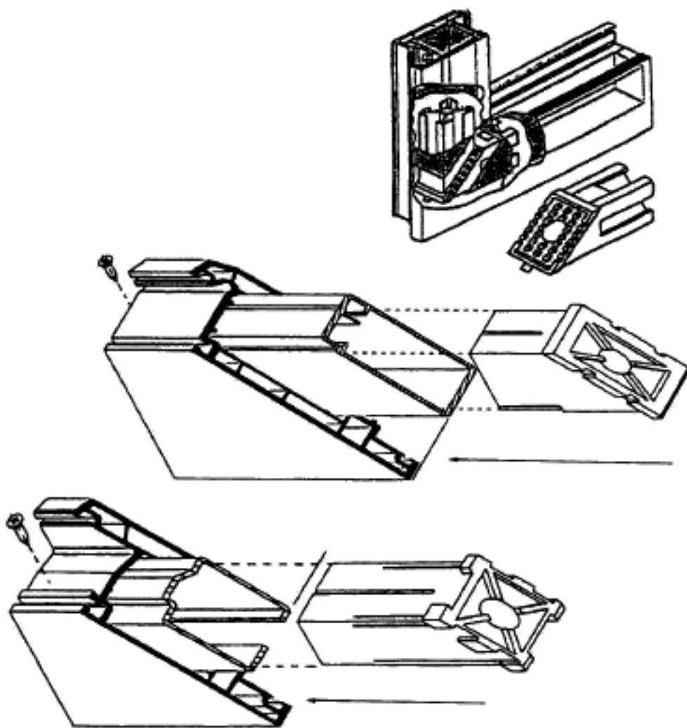
*Рисунок 8 — Примеры установки вкладыша для усиления угловых соединений*
