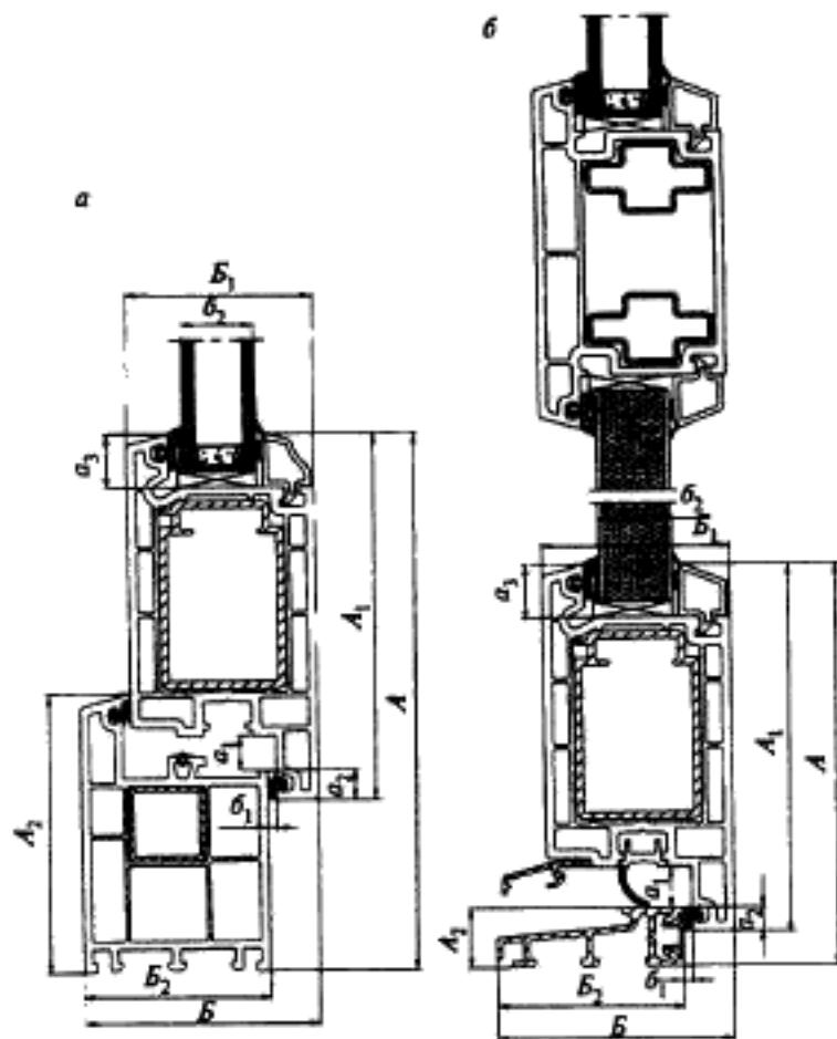
*a* — остекленное стеклопакетом; *b* — светлое, с заполнением верхней части полотна стеклом; *2* — светлое, с заполнением верхней части полотна стеклопакетом
