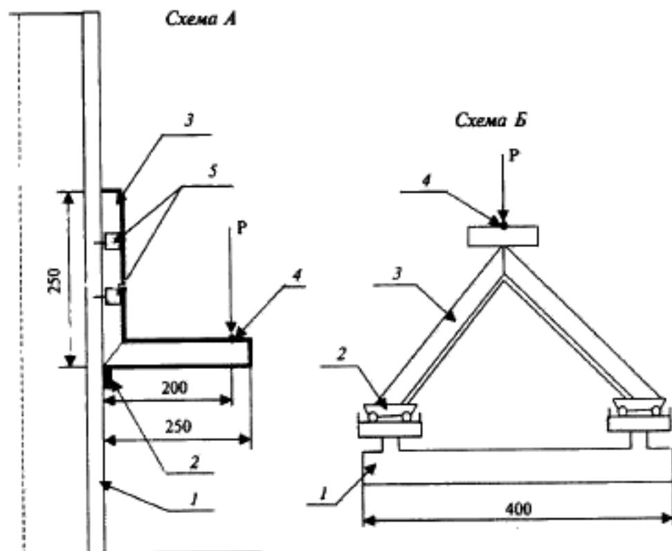
1 — опора; 2 — упор (для схемы Б — каретки); 3 — образец; 4 — точка приложения нагрузки; 5 — съемные хомуты крепления
