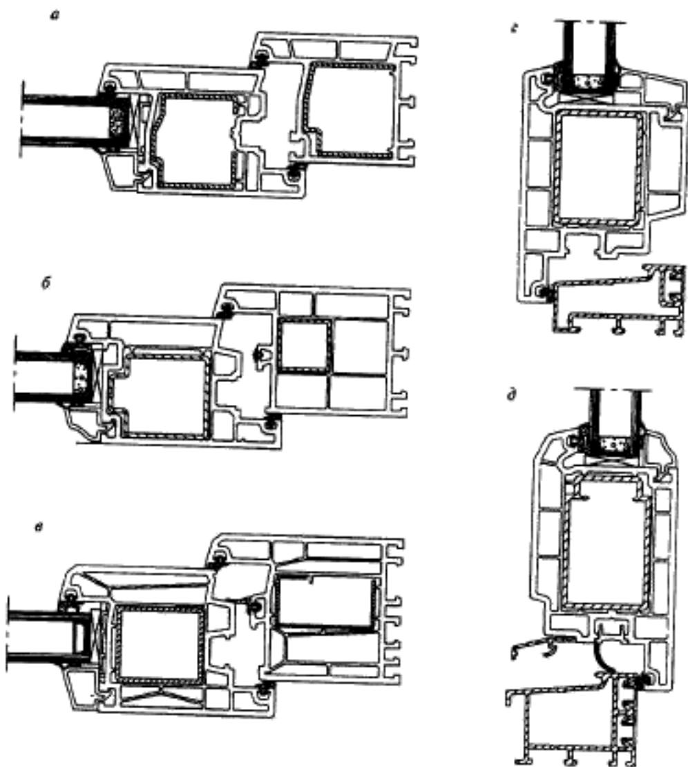
*а, б — дверные системы с наружным и внутренним уплотнениями; в — дверная система с наружным, средним и внутренним уплотнениями; г — дверная система с наружным уплотнением; д — дверная система со средним и внутренним уплотнениями*
