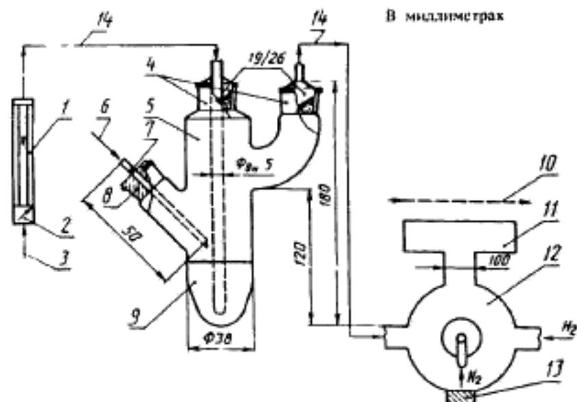
1 — расходомер; 2 — игольчатый клапан; 3 — подача газа-носителя; 4 — стеклянные конические соединения; 5 — реактор; 6 — впрыскивание боргидрида натрия с помощью шприца; 7 — игла; 8 — пробка-штулка; 9 — испытуемый раствор; 10 — оптический путь спектрометра; 11 — горелка; 12 — распылитель; 13 — нитриллатонная заглушка для вывода избыточного газа; 14 — соединительные гибкие трубки
