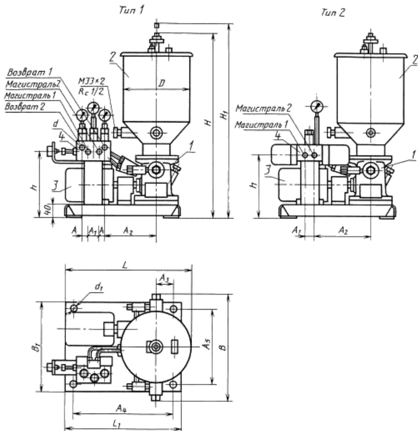
1 — насос; 2 — резервуар; 3 — электродвигатель; 4 — двухмагистральный распределитель
