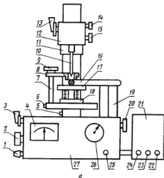
осность индентора и отверстия в прижимной лапке можно визуально оценить при помощи зеркала, помещенного на пружинный стол. После установления соосности поднимают испытательную головку.
