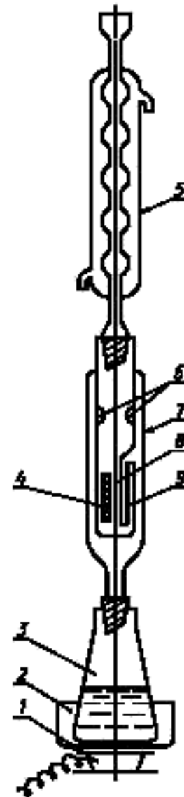
1 — электроплитка, 2 — песочная баня; 3 — колба с n -гептаном; 4 — патрон с полимером; 5 — шариковый холодильник; 6 — отверстия; 7 — экстрактор; 8 — ловушка экстрактора; 9 — сифон
