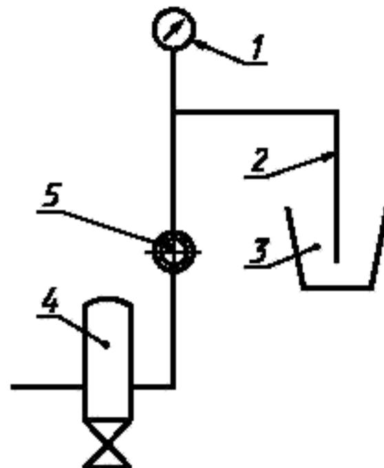
1 — манометр; 2 — сопло (форсунка); 3 — воронка с ситом;
