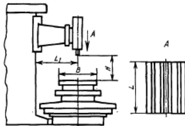
$L_1$  — расстояние от оси шпинделя до направляющей поверхности колоды (вылет шпинделя);
