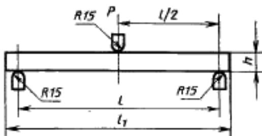
1.4.2. Образец нагружают равномерно с постоянной скоростью нагружения. Скорость должна быть такой, чтобы образец разрушился через  $(60 \pm 30)$  с после начала нагружения. Максимальную нагрузку  $P_{\max}$  измеряют с погрешностью не более 1%.
