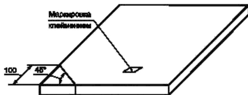
Рисунок Б.1 — Расположение маркировочных полос
