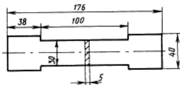
2. Заготовку рихтуют и шлифуют на глубину 0,2—0,3 мм. Параметр шероховатости поверхности  $R_a \leq 1,6 \text{ мкм}$  по ГОСТ 2789.
