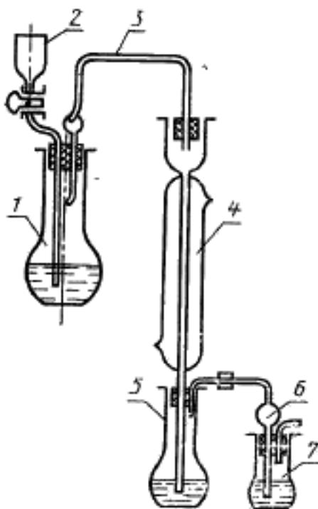
1 — перегонная колба; 2 — капельная воронка; 3 — трубка с гидрозатвором; 4 — холодильник; 5 — приспособление; 6 — гидрозатвор; 7 — контрольный приемник
