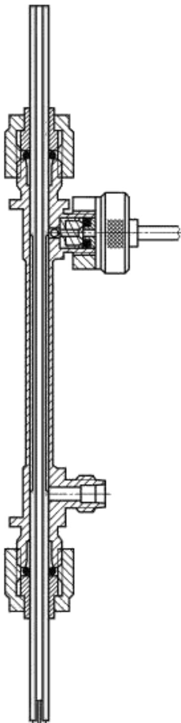
Рисунок А2.2 — Сборочный чертеж испытательной секции трубы подогревателя
