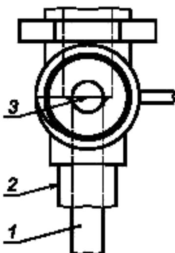
1 — трубка подогревателя; 2 — кожух трубы подогревателя; 3 — плечико трубы подогревателя в центре сливного отверстия
