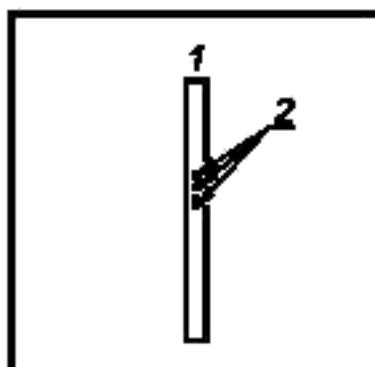
T — длина испытательной площади — 60 мм; 2 — примеры площади  $2,5 \text{ mm}^2$ : квадрат, пятна, полоска шириной 0,8 мм
