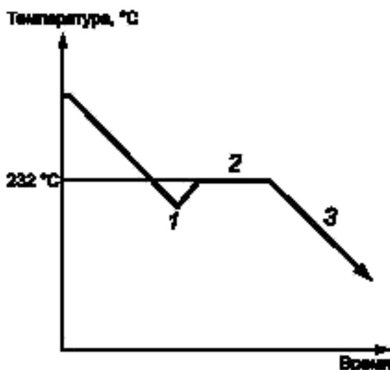
1 — переохлаждение; 2 — застывание, 3 — твердое состояние
