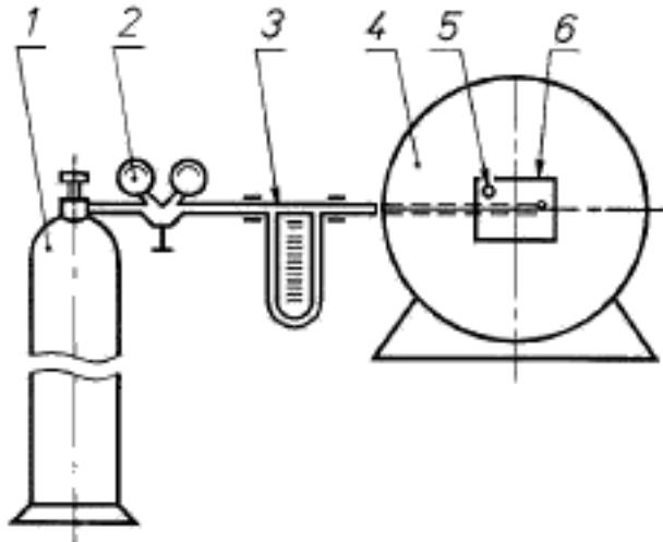
1 — баллон с кислородом; 2 — манометр; 3 — реометр; 4 — муфельная печь; 5 — отверстия для термопары; 6 — отверстие для трубы
