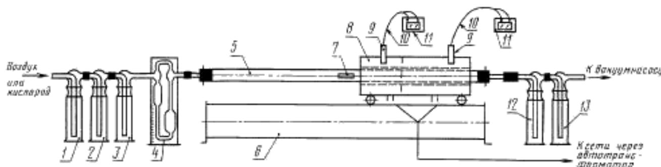
1, 2, 3 — склянки для очистки воздуха; 4 — реометр; 5 — кварцевая или фарфоровая труба; 6 — подставка для печи; 7 — фарфоровая лодочка; 8 — электрическая трубчатая печь; 9 — отверстие для термометра; 10 — термоэлектрический термометр; 11 — молибдевый термометр; 12, 13 — поглотительные склянки
