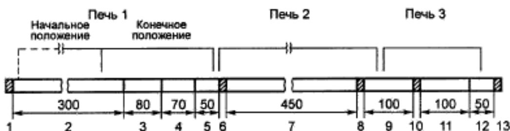
1 — резиновая пробка; 2 — пустое пространство; 3 — спираль из медной сетки; 4 — лодочка с навеской; 5 — пустое пространство; 6, 8, 10 — пробка в виде рулона из медной сетки; 7 — оксид меди; 9 — хромат свинца; 11 — спираль из серебряной сетки; 12 — пустое пространство; 13 — термостойкая пробка
