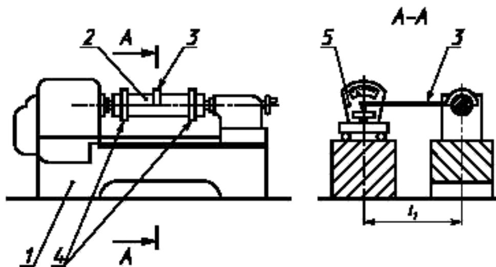
1 — станина стенда со шпинделем и задней бабкой для зажима и приведения оси ролика во вращение; 2 — испытуемый ролик; 3 — рычаг; 4 — кольцо нагруженное; 5 — силоизмерительное устройство
