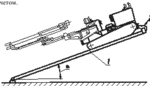
Рисунок 1 — Схема проверки продольной статической устойчивости установки
