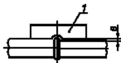
Рисунок 10 — Схема определения смещения кромок стыкуемых труб
