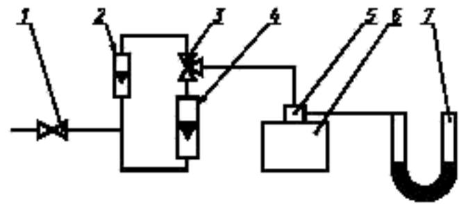
1 - регулирующий вентиль; 2 - расходомер с верхним пределом измерения 0,1 м<sup>3</sup>/ч; 3 - трехходовой кран; 4 - расходомер с верхним пределом измерения 4 м<sup>3</sup>/ч; 5 - присоединительное устройство; 6 - ДМ; 7 - мановакуумметр
