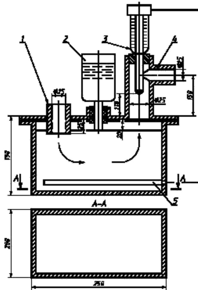
1 — штуцер, направленный к ИЛ; 2 — подвизающий резервуар; 3 — терморегулирующее устройство; 4 —штуцер, направленный к тройнику; 5 — электронатреватель
