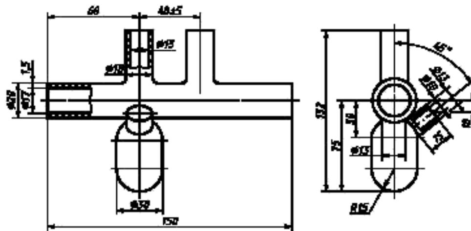
Рисунок Б.1 — Схема резервуара психрометра
