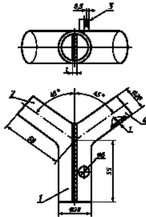
1 — выходной патрубок тройника; 2 — патрубок, направленный к линии выдоха установки ИЛ; 3 — штуцер для установки термоэлектрического преобразователя; 4 — патрубок, направленный к линии вдоха установки ИЛ
