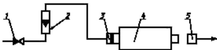
1 — регулирующий вентиль; 2 — расходомер; 3 — присоединительное устройство; 4 — регенеративный патрон РП; 5 — патный тампон
