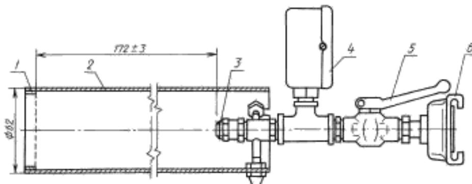
1 — сетка; 2 — корпус; 3 — распылитель; 4 — манометр; 5 — кран; 6 — головка напорная ГМ-50
