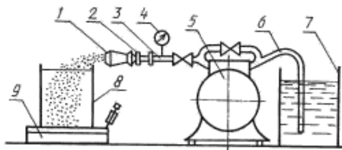
1 — пенный пожарный ствол; 2 — рукав напорный; 3, 4 — патрубок с манометром; 5 — насос; 6 — рукав всасывающий; 7, 8 — емкость; 9 — весы
