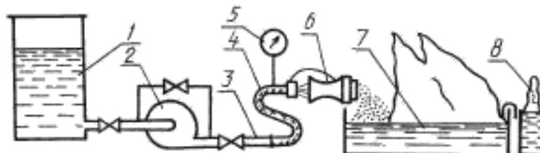
1 — емкость; 2 — насос; 3 — трубопровод; 4 — рукав; 5 — манометр; 6 — пеногенератор; 7 — противень; 8 — титуль
