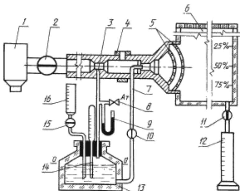
1 — источник воздуха; 2, 10, 11, 15 — кран; 3, 7 — трубка; 4 — заслонка; 5 — сетка; 6 — емкость; 8 — клапан;
