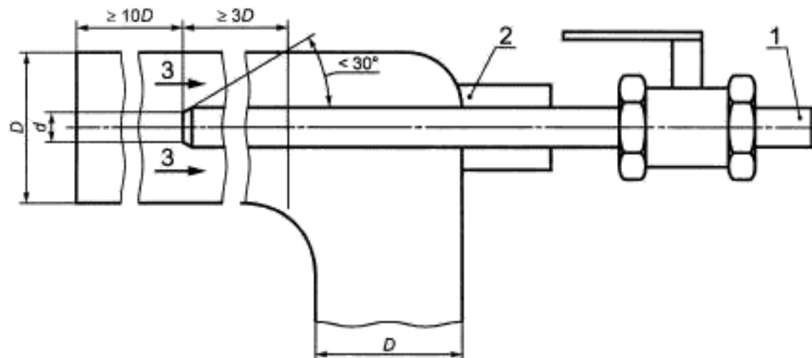
1 — пробоотборник в основном трубопроводе; 2 — муфта для регулирования пробоотборника при установке;
