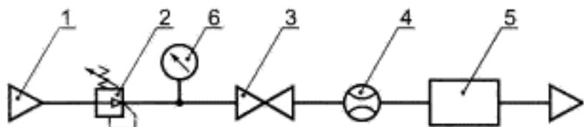
1 — система сжатого воздуха (точка отбора проб); 2 — регулятор давления; 3 — игольчатый клапан;
