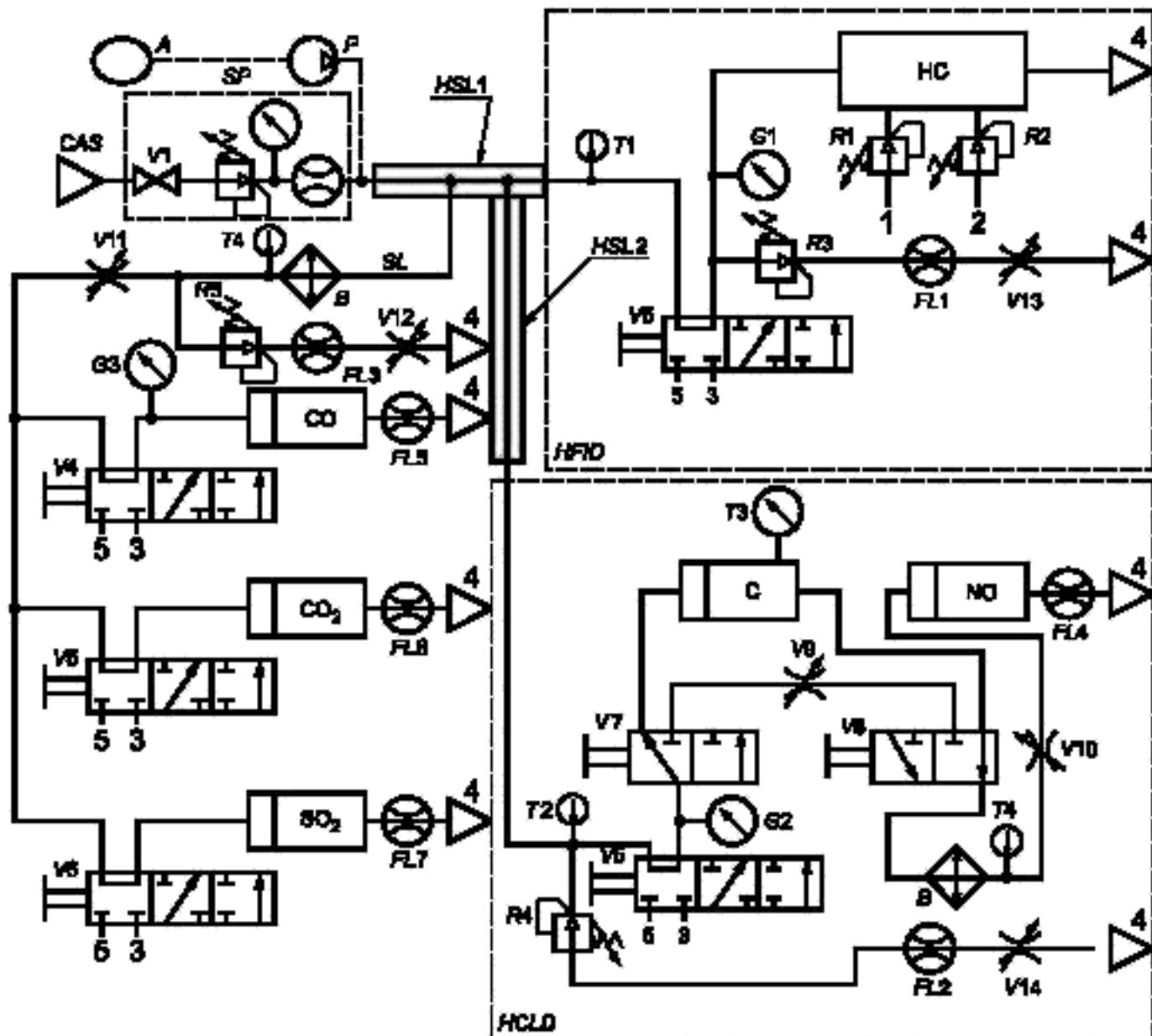
1 — воздух; 2 — топливо, 3 — проба газа; 4 — вентиляционное отверстие; 5 — эталонный газ
