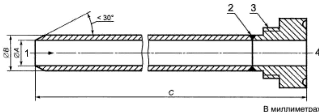
1 — направление потока воздуха; 2 — гладкое высококачественное соединение; 3 — герметичное резьбовое соединение; 4 — часть пробоотборника, присоединяемая к держателю мембранны
