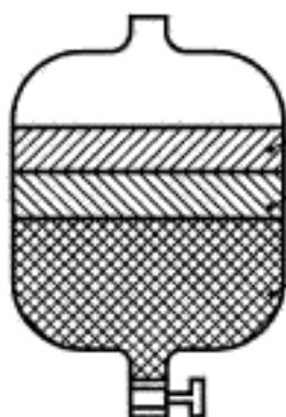
Рисунок 8 — Сепаратор для разделения масла и воды
