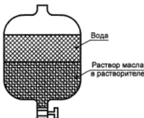
Рисунок 9 — Сепаратор для извлечения масла растворителем
