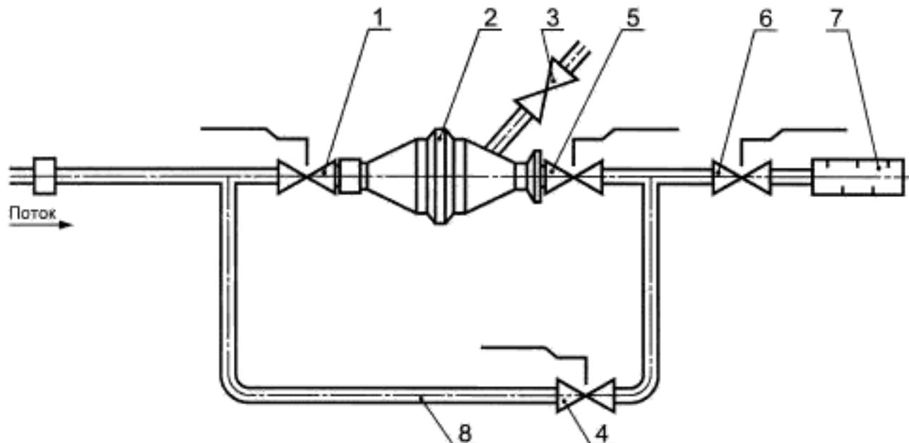
1, 4, 5 — запорные шаровые клапаны для полного потока воздуха; 2 — патрон мембранные, 3 — клапан сброса; 6 — вентиль регулирования потока; 7 — глушитель; 8 — обводная труба
