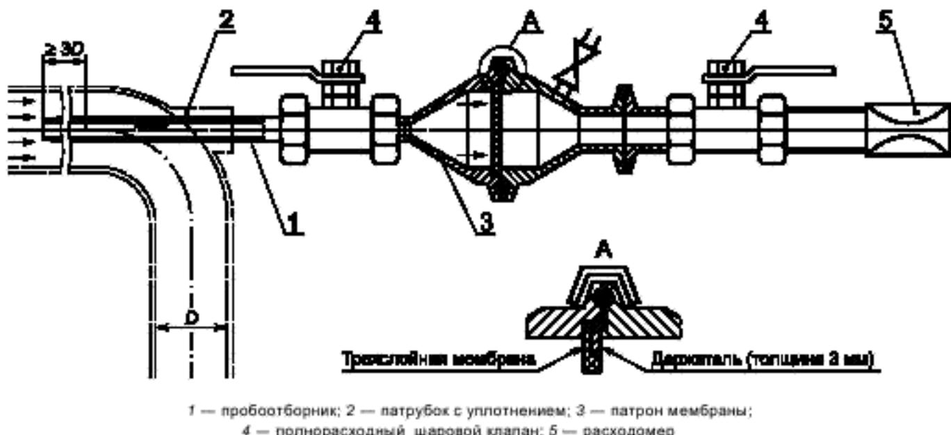
Рисунок 5 — Оборудование для изокинетического отбора проб в месте изгиба трубы по методу В2
