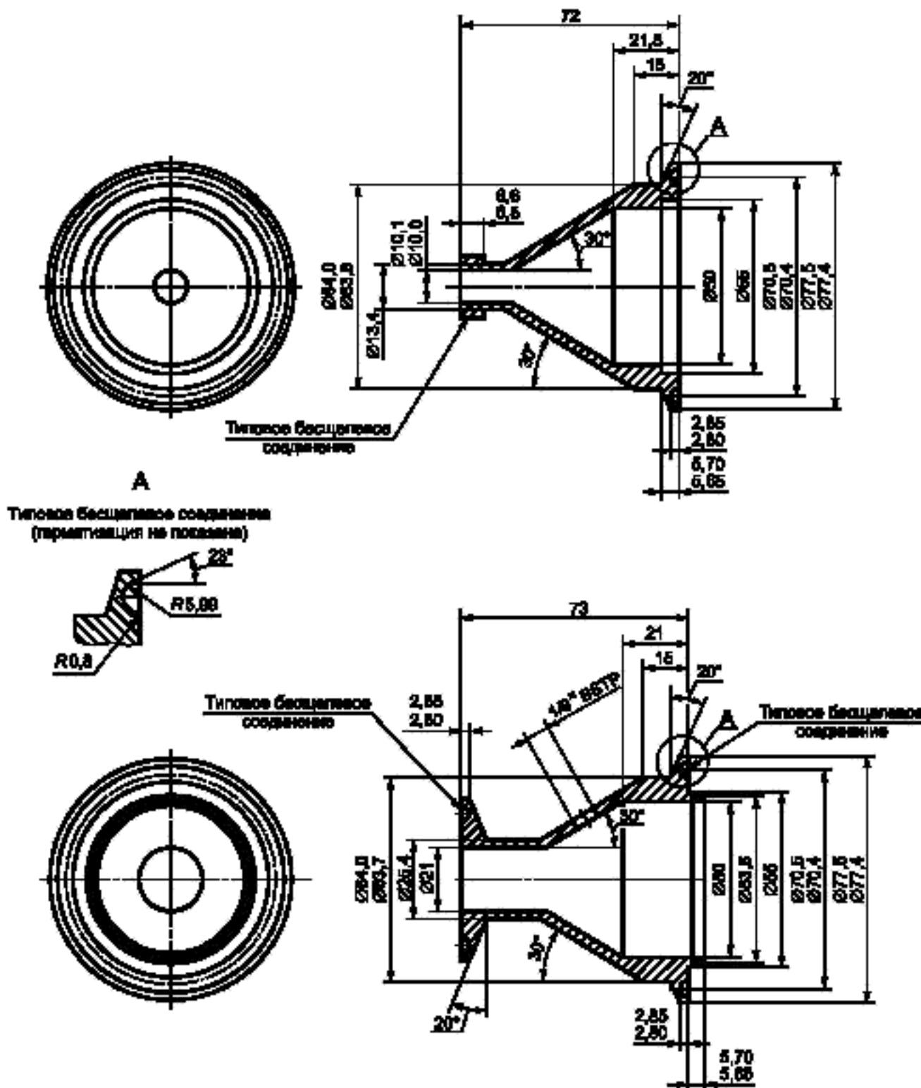
Рисунок 4 — Пример типового патрона мембранны
