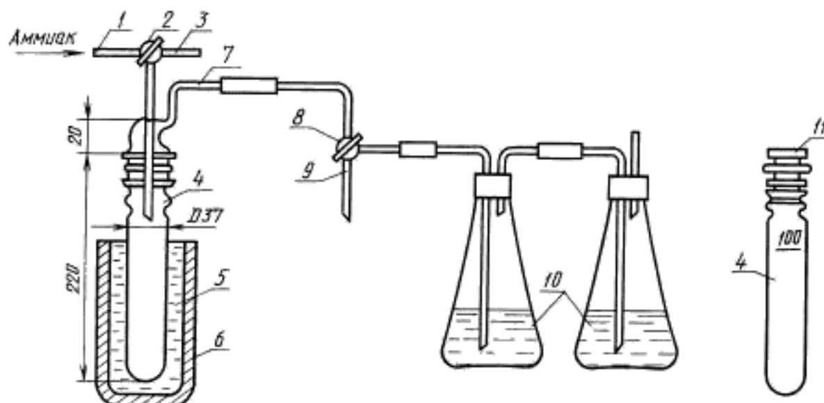
1, 3, 7, 9 — трубка; 2, 8 — трехходовой кран; 4 — пробоотборная пробирка; 5 — сосуд Дьюара; 6 — охлаждающая смесь;
