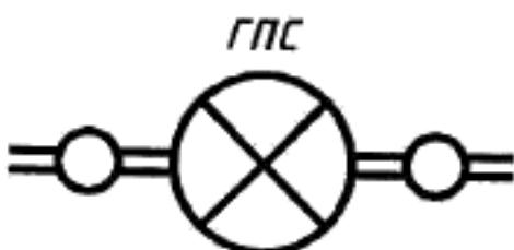
— газопровод с газокомпрессорной станцией
