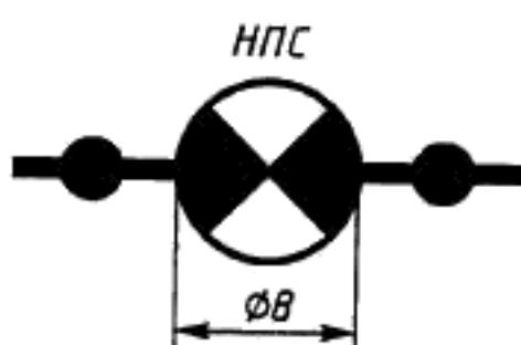
— нефтепровод с перекачивающей станцией
