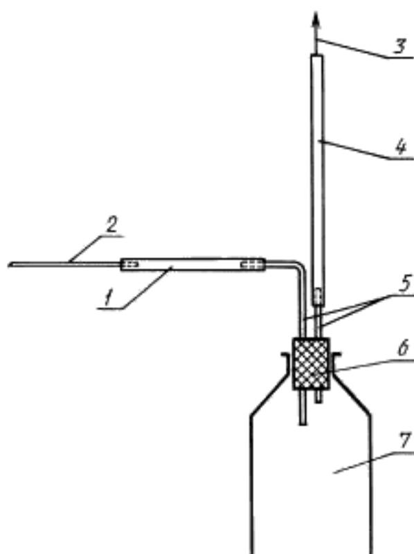
1 — трубка ПЭНД  $d_y = 6$  мм,  $l = 600—700$  мм; 2 — острый никонечник для отбора пробы из мешка (титан или нержавеющая сталь  $d_y = 5$  мм,  $l = 150$  мм); 3 — вакуум-насос; 4 — трубка ПЭНД  $d_y = 6$  мм, 5 — трубка из титана или нержавеющей стали  $d_y = 6$  мм; 6 — пробка резиновая; 7 — бутыль или колба из толстостенного стекла вместимостью 1—2 дм<sup>3</sup>.
