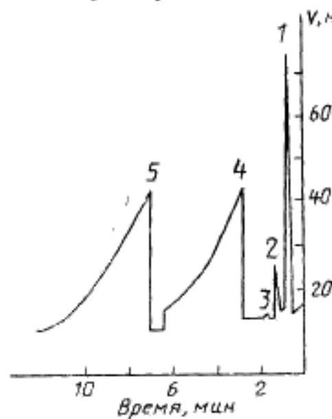
1—воздух; 2—двуокись углерода; 3—вода; 4—ацетальдегид; 5—окись этилена
