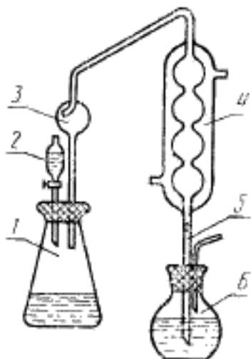
1—коническая колба; 2—капельная воронка; 3—бронзовый брызгоуловитель; 4—толстостенная; 5—отводная трубка; 6—приемник
