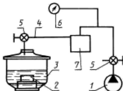
1 — вакуумный насос по ГОСТ 26099; 2 — образцы изделий; 3 — вакуумный экскаватор исполнения I по ГОСТ 25336 или любая другая разъемная емкость с вакуумным уплотнением; 4 — вакуумный шланг; 5 — вакуумный кран; 6 — образцовый манометр по ГОСТ 2405; 7 — ловушка
