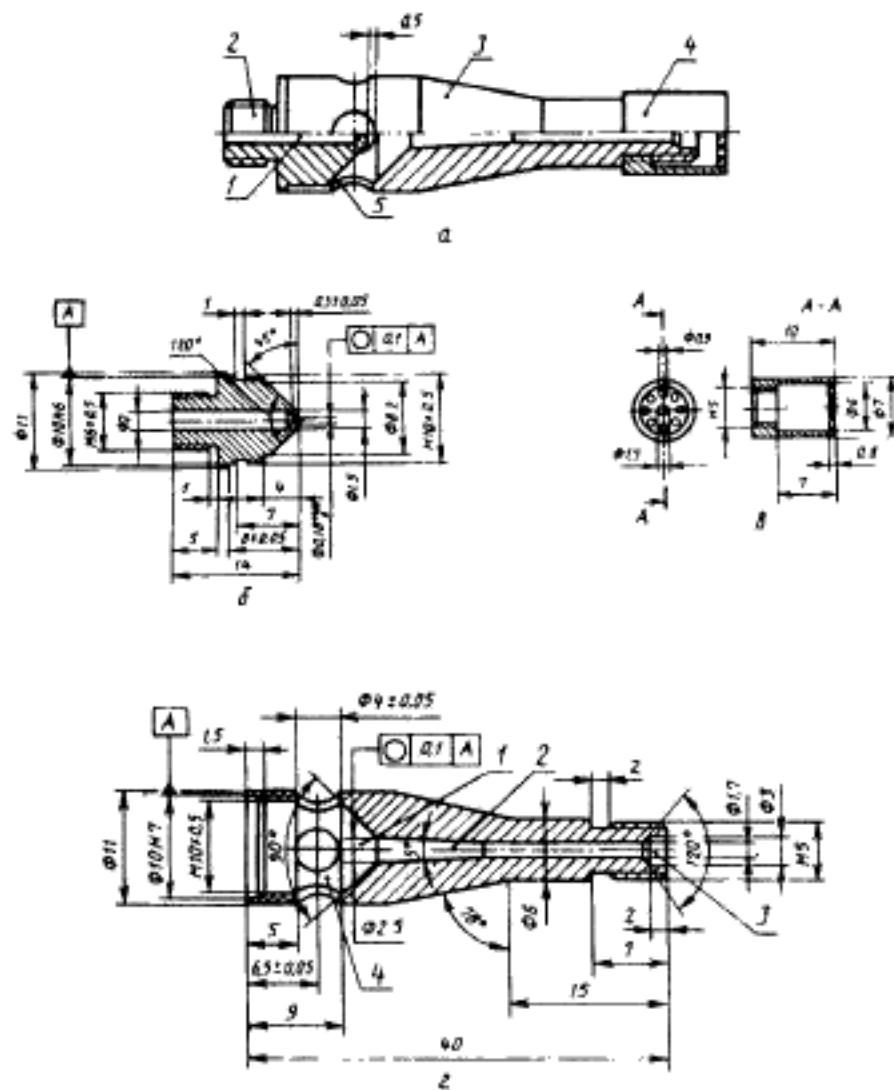
**a** — общий вид горелки; 1 — дроссельная трубка, 2 — газовое сопло, 3 — трубка горелки, 4 — стабилизатор пламени, 5 — выемка;
