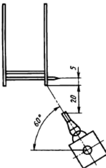
Рисунок 4 — Испытания с кромки
