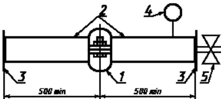
1 — муфта; 2 — трубопровод; 3 — заглушка; 4 — манометр (вакуумметр); 5 — запорное устройство
