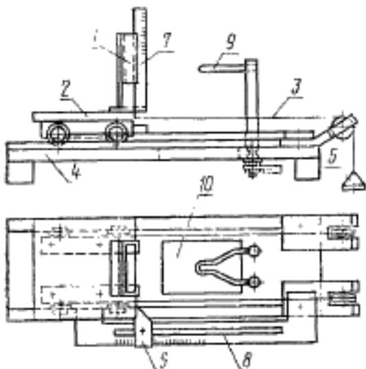
1 — зажим для закрепления образца; 2 — тележка;
