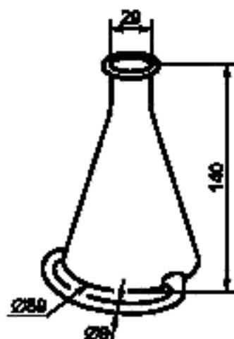
Рисунок 1 — Коническая колба с отводной трубкой
