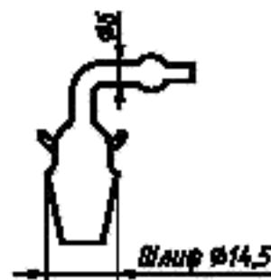
Рисунок В.6 — Шлиф с отводной трубкой
