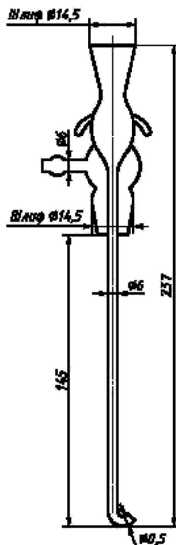
Рисунок В.3 — Аллонж с газоотводной трубкой
