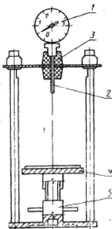
1 — манометр; 2 — игла; 3 — уплотнительная прокладка; 4 — площадка пресса; 5 — винт
