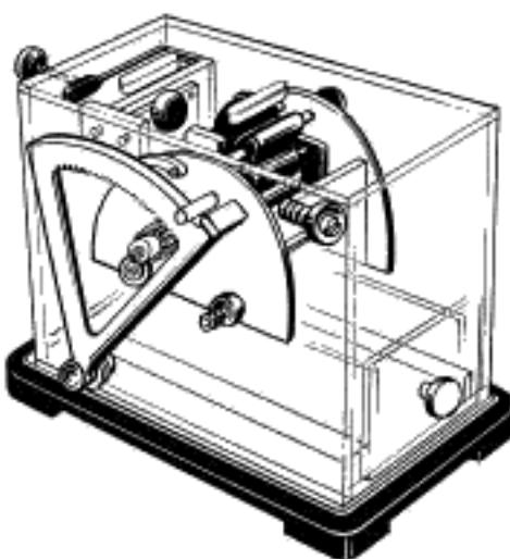
Схематический разрез прибора «Синазе»
