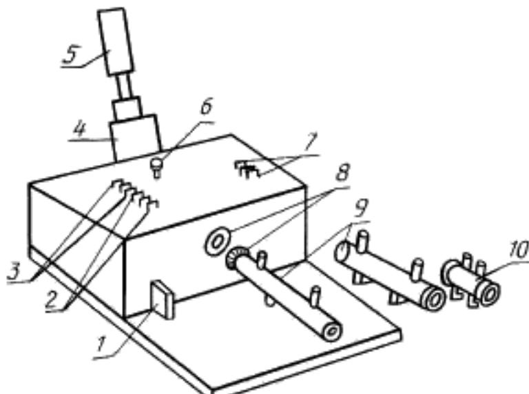
1 — кюветы для масла толщиной 10 мм; 2 — набор желтых светофильтров; 3 — набор красных светофильтров; 4 — кожух призмы; 5 — окуляр; 6 — ручка перемещения клина; 7 — набор нейтральных светофильтров; 8 — верхнее и нижнее окна прибора; 9 — кюветы для масла толщиной 130 мм; 10 — кювета для масла толщиной 50 мм
