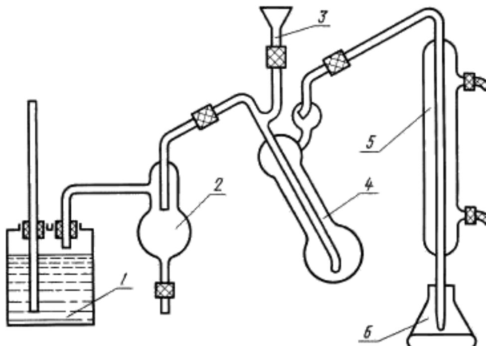
1 — парообразователь; 2 — предохранительный сосуд; 3 — воронка; 4 — колба-смеситель; 5 — холодильник; 6 — колба-приемник
