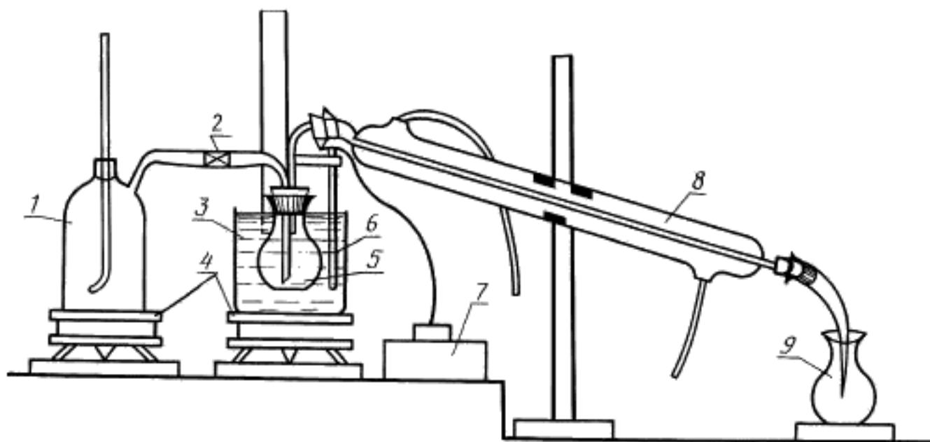
1 — парообразователь; 2 — кран; 3 — глицериновая баня; 4 — нагревательный прибор; 5 — отгонная колба; 6 — термометр; 7 — терморегулирующее устройство; 8 — холодильник; 9 — приемная колба
