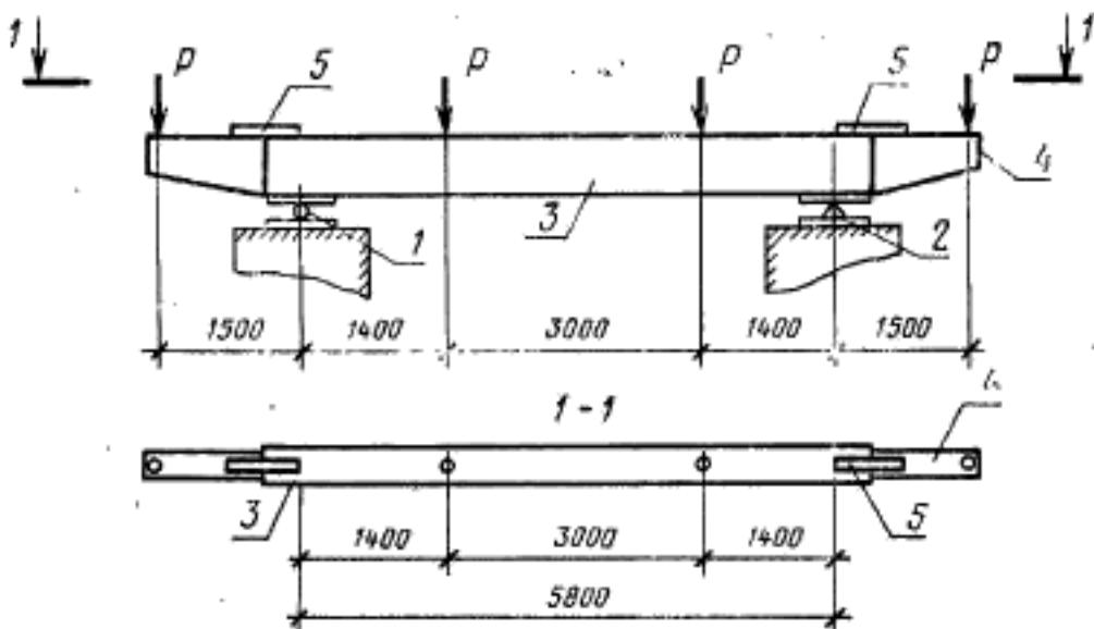
1—подвижная опора; 2—неподвижная опора; 3—балка; 4—стальная консоль; 5—стыкованная накладка (4 и 5—по расчету)
