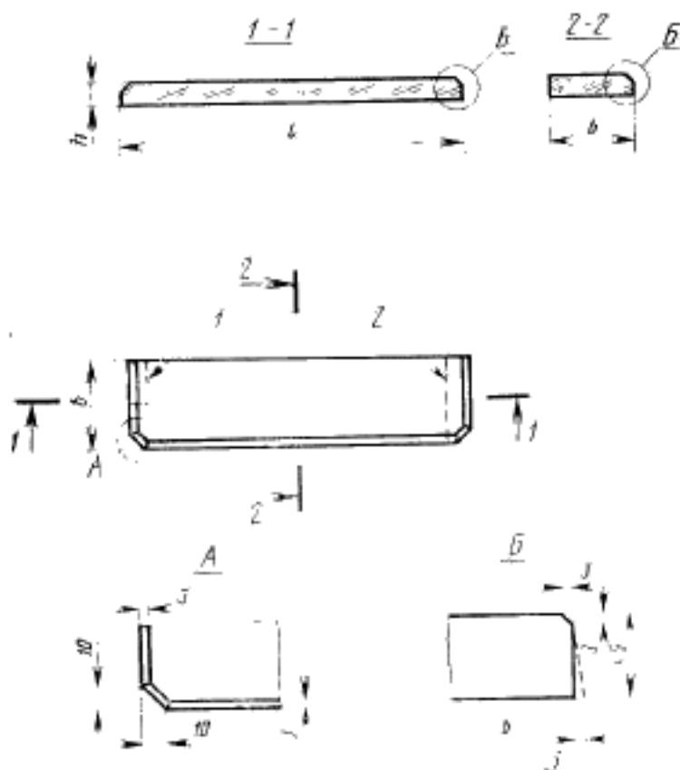
1—вырез 2—срез торца, 3—технологический уклон не более
