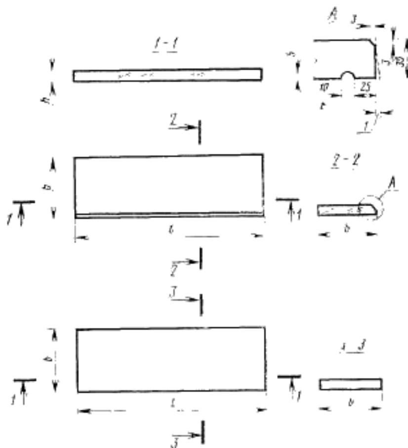
$t$  — технологический уклон не более 2 мм
