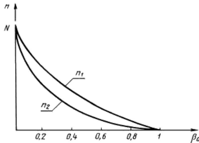
Рисунок B.1 — Зависимость объемов выборок для одноступенчатого (верхняя кривая  $n_1$ ) и двухступенчатого (нижняя кривая  $n_2$ ) контроля от риска потребителя при контроле поставщика  $\beta_0$  для объема партии  $N$
