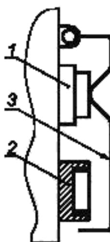
1 — кнопка «Выкл.»; 2 — кнопка «Вкл.»; 3 — защитный кожух
